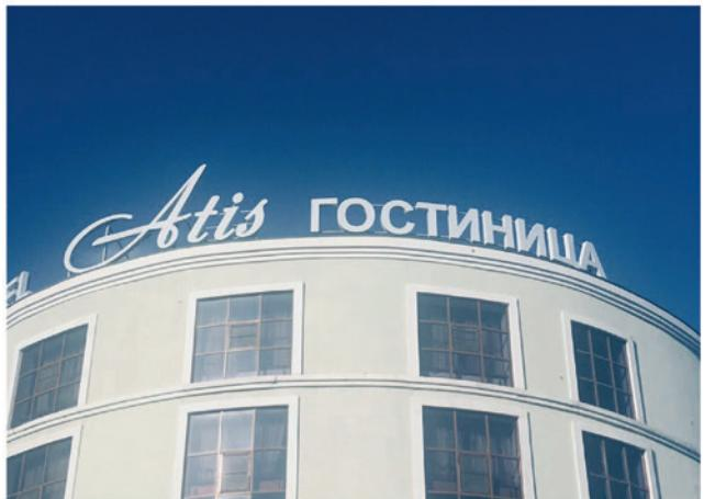
Крышная установка – это массивная рекламная конструкция, которая устанавливается на крышу здания или сооружения в рекламных или имиджевых целях. Световые буквы, лайтбоксы, светодиодные панно – вот основные элементы такой наружной рекламы. Производственный процесс должен вестись с учетом повышенных нагрузок и длительного срока эксплуатации.
