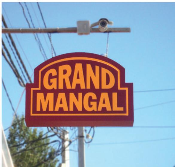
**Рекламная консоль** – это один из видов наружных конструкций с торцевым креплением к стене. Консольная вывеска очень эффективна на узких тротуарах и зачастую может служить дополнением к основному лайтбоксу.
